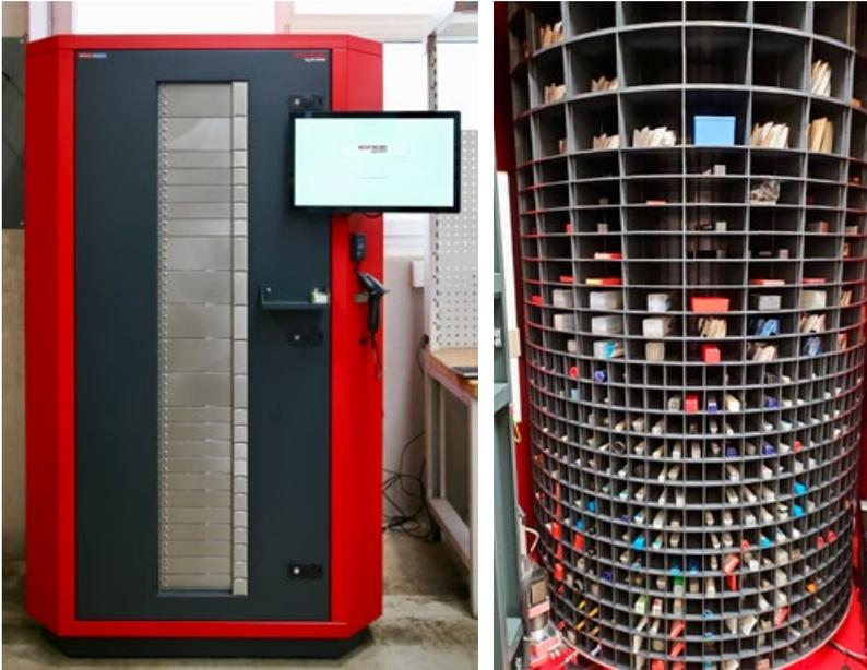
**Drei StoreManager Pro** übernehmen bei Penn die strukturierte Werkzeugausgabe – mit Einzelentnahme und direkter ERP-Anbindung. (Bilder: x-technik)
