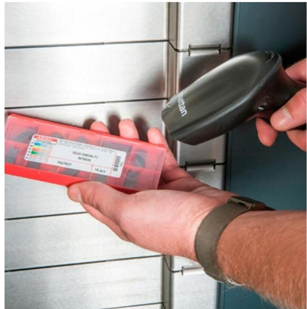
**links Über RFID und Volltextsuche** wird jedes Werkzeug im StoreManager zielgenau gefunden und die Entnahme automatisch dokumentiert.
