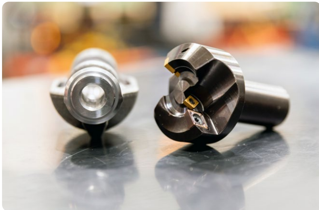
Das Glockenwerkzeug (SOE-108604) vereint mehrere Bearbeitungsschritte in einem Werkzeug – darunter das stirnseitige Anspiegeln, Zirkularfräsen und Fasenbearbeiten. (Anm.: Stirnseitig anspiegeln (Tiefe 2,7 mm); Außen-Zirkularfräsen \varnothing 23,0 mm; Außenfase \varnothing 26,0 mm x 45°; Außenfase 0,5 mm x 45°; Drehzahl: 2.400 U/min; Vorschub: 250 mm/min)
