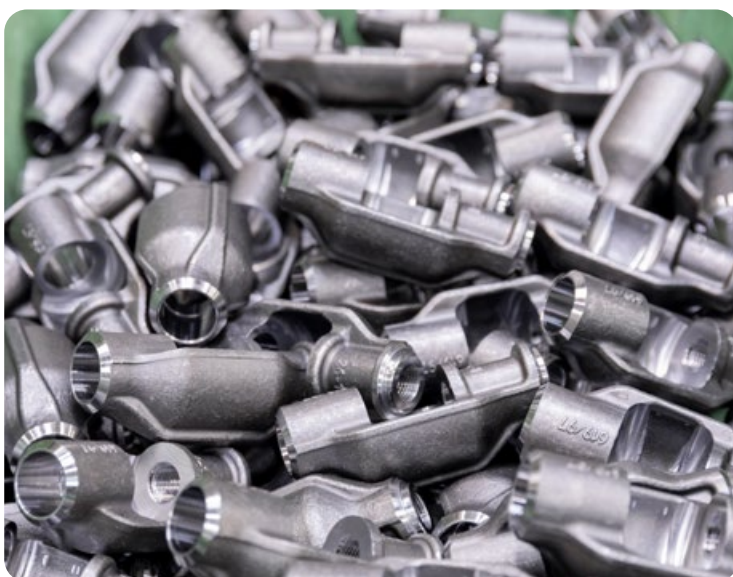
Die Federbein-Versteifung aus 25CrMo4-Vergütungsstahl wird bei Stubai KSHB komplett bearbeitet und in Stückzahlen von bis zu 20.000 Teilen pro Jahr gefertigt.
