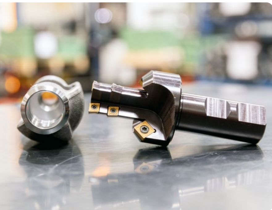
Das Aufbohr-Glockenwerkzeug (SOE-108605) bündelt mehrere Bearbeitungsschritte in einem Werkzeug und reduziert dadurch Werkzeugwechsel und Nebenzeiten. (Anm.: Aufbohren \varnothing 21,80 mm; Aufbohren \varnothing 22,50 mm; Außenfase \varnothing 24,40 mm x 45°; Drehzahl: 2.400 U/min; Vorschub: 500 bzw. 170 mm/min)
