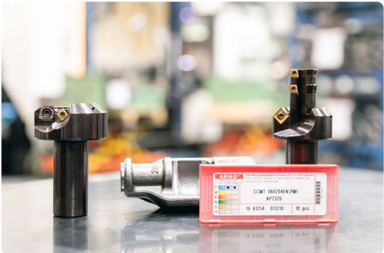
Die beiden Sonderwerkzeuge mit Standard-Wendeschneidplatten ermöglichen eine Taktzeitreduzierung von rund 3,5 Minuten pro Bauteil.
