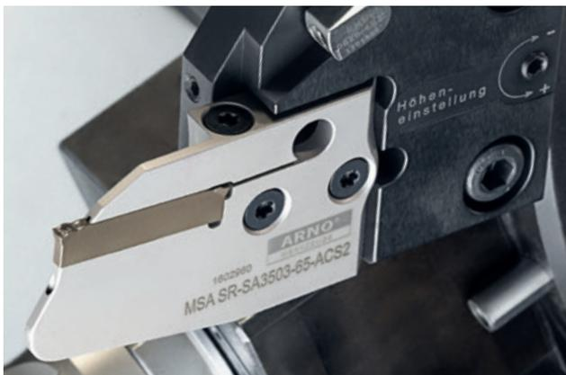
**Optimale Kombi – Direktaufnahmen und Stechmodule.**
