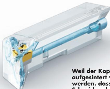
Weil der Kopf des Klemmhalters im 3D-Verfahren aufgesintert wird, können die Kühlkanäle so geführt werden, dass Kühlflüssigkeit höchst effizient bis zum Schneidwerkzeug geführt wird und von oben und von unten direkt an die Schneide gelangt.
