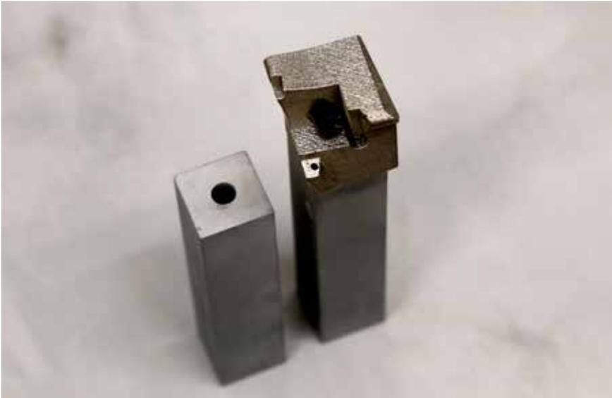
**Auf einen Grundkörper aus vorvergütetem Stahl** wird mit 1.2709-Pulver der Werkzeugkopf aufgebracht. Kühlmittelkanäle können dabei nahezu frei definiert werden. (Bilder: x-technik)
