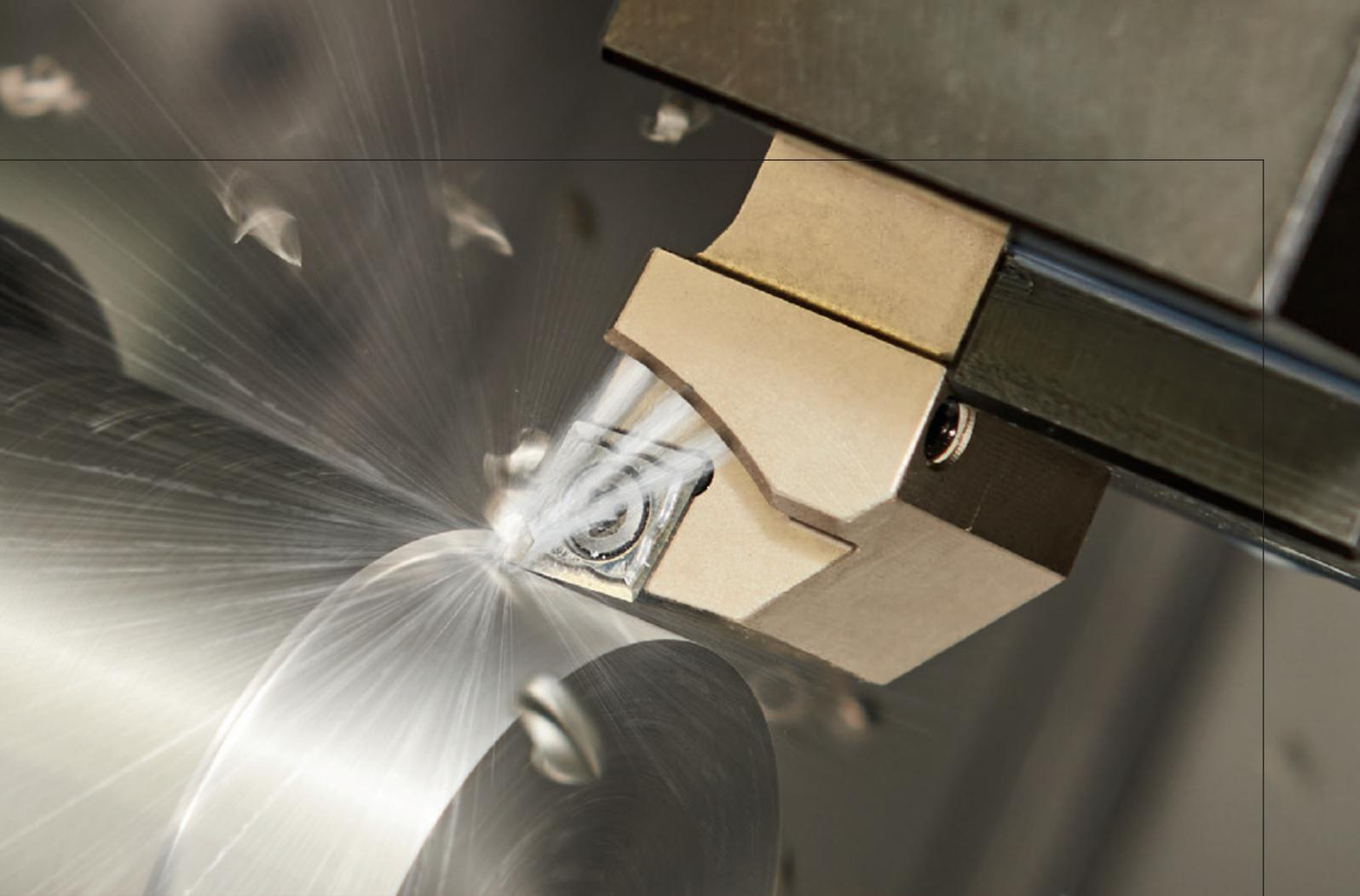
**ARNO INFO** // Drei Kühlmitteldüsen bei den Trägerwerkzeugen garantieren eine optimale Spanabfuhr.
